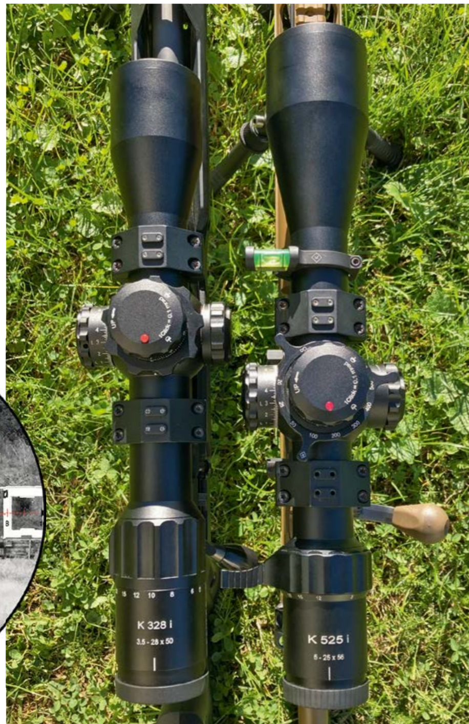
Das K328i mit einem um zwei Millimeter gewachsenen Mittelrohrdurchmesser wurde im direkten Vergleich zum K525i geschossen.
