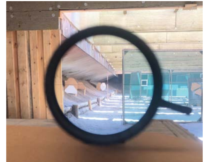
K18i bei einfacher Vergrößerung: Wie hier gut an den Rahmenlinien und der Blende zu sehen ist, ist das K18i ein „echtes“ 1x Glas. Es entstehen keine sichtbaren Verzerrungen/ungewollte Vergrößerungen beim Blick durch das Zielfernrohr. Es kann somit wie ein klassisches Leuchtpunktvisier genutzt werden. Beleuchtung hier auf Stufe 9 noch ohne zugeschaltetes „Max Light“.
