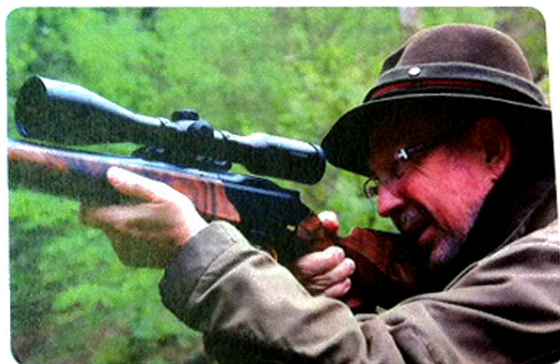
La distance oculaire de 95 mm met les arcades sourcilières de l'utilisateur à l'abri du recul.
