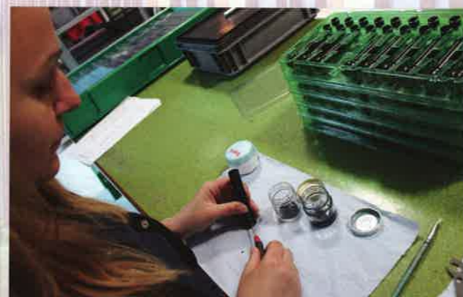
Zusammenbau des Umkehrsystems - Feinmechanik pur
