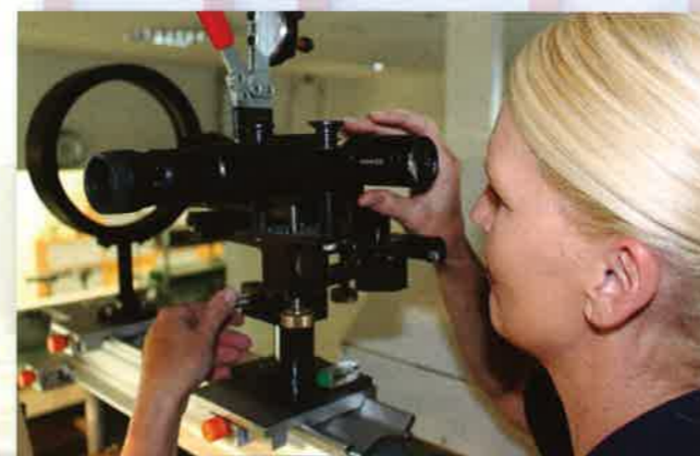
Ein Kahles Zielfernrohr bei der finalen Justierung und technischen Abnahme, bevor es zum Verkauf freigegeben wird
