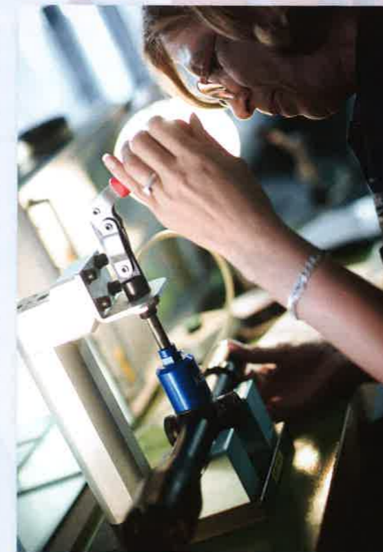
Diese Kahles Mitarbeiterin füllt das Zielfernrohr gerade mit Stickstoff
