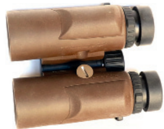
Dalekohled Kahles Helia RF 8x42 zespodu. Dvě „boule“ na spodku obsahují dálkoměr. Je to stejné řešení, jaké používá firma Swarovski u svých dálkoměrů EL Range. Na rozhraní pravého tubusu a můstku je šachta pro baterii, uzavřená šroubovacím víčkem.
