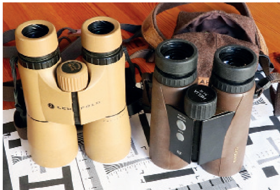
Dalekohled Leupold 10x50 a dálkoměrný Kahles Helia RF 8x42 na pozadí kontrolního obrazce ISO 12233, pomocí kterého zkoumám optické kvality dalekohledů.
