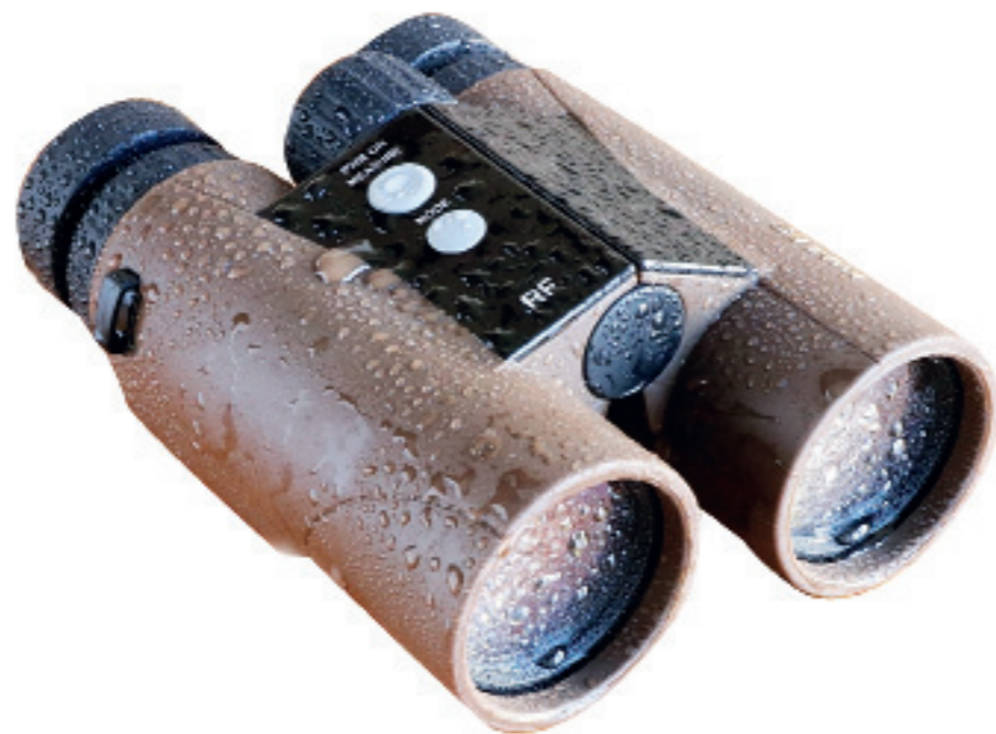
Kahles Helia RF 8x42 po sprchovém testu. V testu obstál, k průniku vlhkosti dovnitř přístroje nedošlo. Povrch dalekohledu je poměrně nesmáčivý, vodoodpudivé vrstvy na čočkách fungují, kapky vody mají tendenci se sdružovat a odpadat, ačkoliv myslím, že Zeiss, Swarovski nebo Meopta mají vodoodpudivé vrstvy o trochu účinnější.
