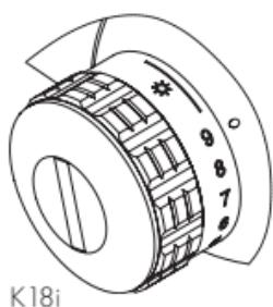
Osvetlenie zámernej osnovy pri modeli K18i je vybavené doplnkovou funkciami MAX LIGHT, ktorá poskytuje potrebnú intenzitu osvetlenia aj pri extrémnom protisvetle. Na dosiahnutie jasnejšieho osvetlenia zámernej osnovy pri funkcií MAX LIGHT sa používa veľmi vysoké napätie batérie, čo znižuje jej životnosť.
