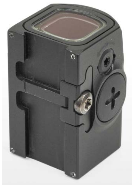
Aimpoint ACRO od spodu – uwagę zwraca bardzo solidny rygiel współpracujący z adapterami pistoletowymi i podstawą na szynę Picatinny, umożliwiającą przenoszenie znacznych obciążeń dynamicznych; drobny zgrzyt to inny rozmiar gniazda w śrubie mocującej, wymagający użycia dodatkowego klucza imbusowego
