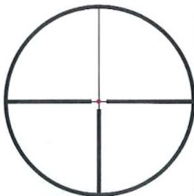
À 100 m, le dot lumineux recouvre un point de 9 cm (1,6x) à 1,8 cm (8x) de diamètre.
