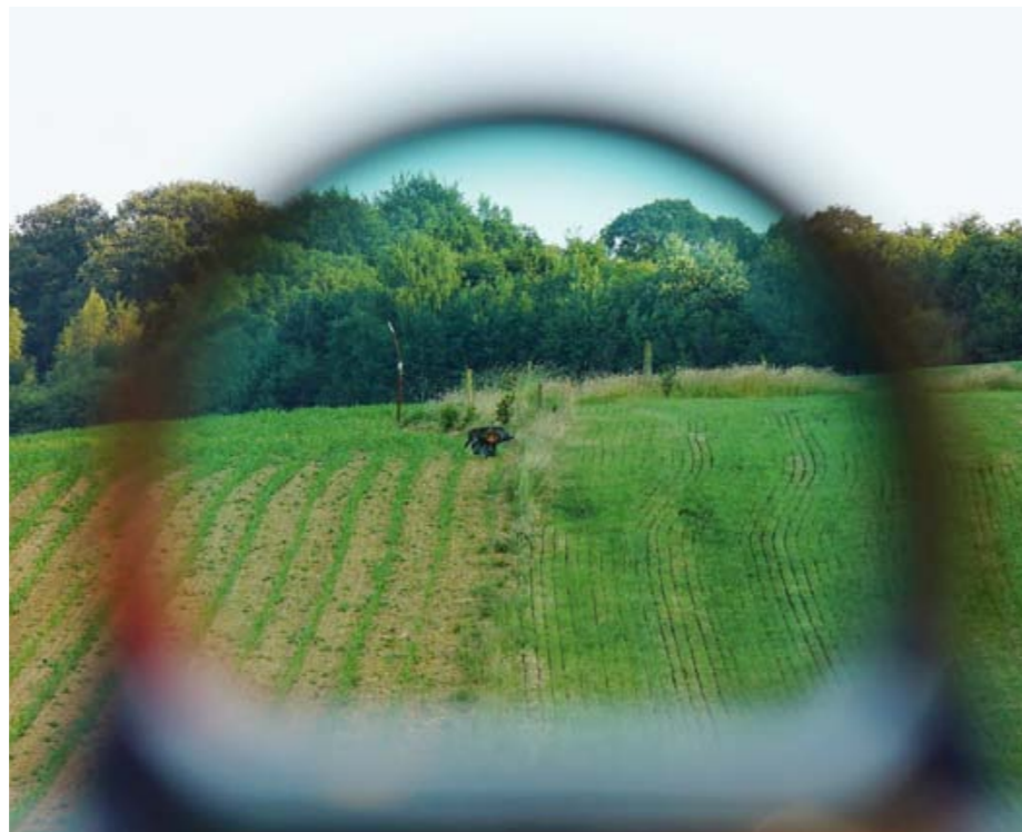
Der 2-MOA-Punkt deckt auf 100 Meter 6 cm ab, damit kann das Helia RD auch bei größeren Entfernungen eingesetzt werden.
