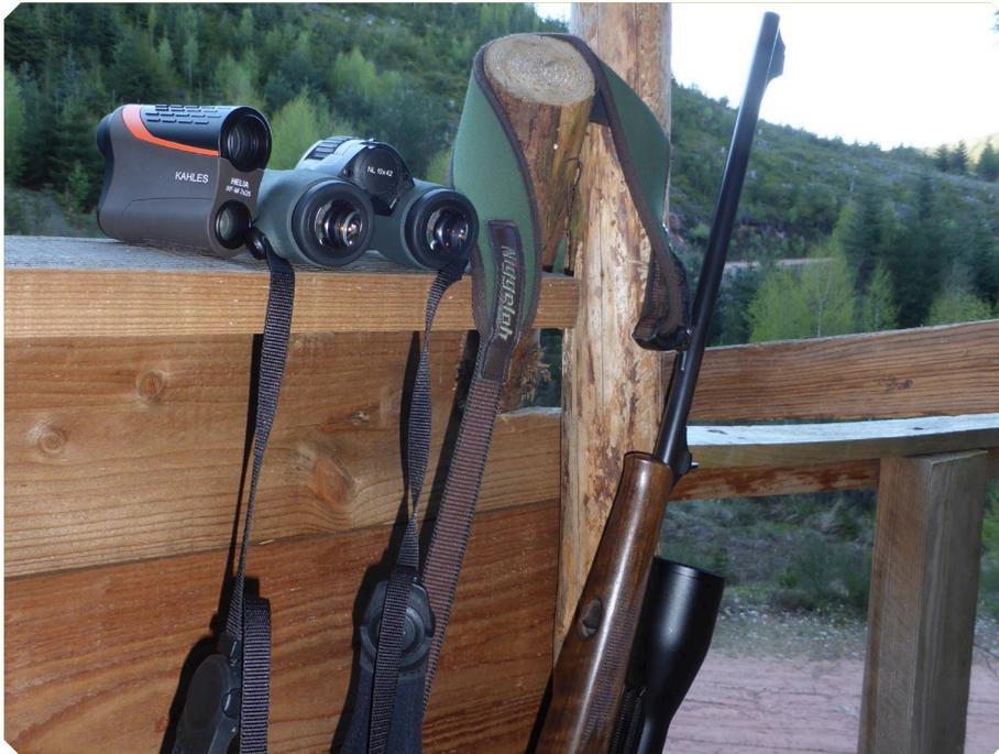
Le fonctionnement, en revanche, est plutôt convivial et intuitif. Une pression sur la touche du haut fait apparaître la distance et le degré de l'angle, si cette deuxième option est sélectionnée. L'affichage reste visible pendant cinq secondes. Cette touche permet par ailleurs d'activer, par un appui prolongé, le mode « scan » pour mesurer en continu, seconde par seconde, la distance d'un animal qui se déplace.
