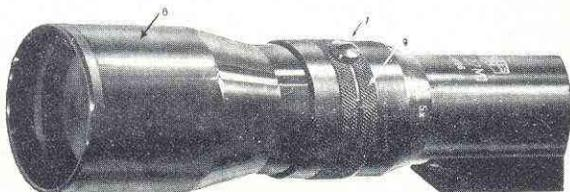
durch Drehen des Okularstutzens (8) bei gleichzeitigem Festhalten des randrierten Ringes (9) eingestellt. Nach erfolgter Einstellung wird die Schraube (7) wieder festgezogen.
